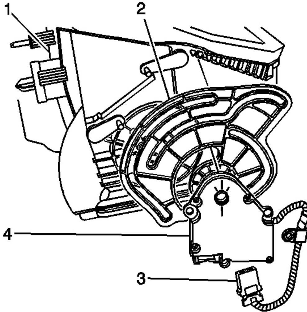
**Fig. 18: Mode Actuator (Visteon)**
