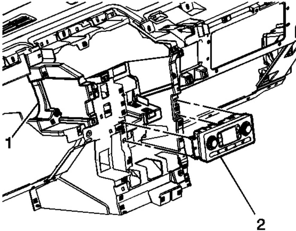
**Fig. 11: HVAC Control Module & I/P Panel**
